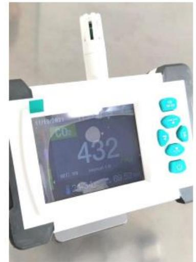
Hicimos pruebas con los equipos de medición de concentración de CO<sub>2</sub>, a fin de determinar los aforos y espacios de ventilación
