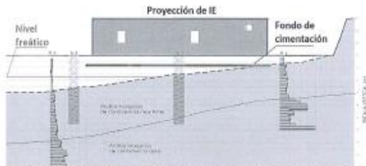
Imagen referencial: Esquema ejemplo de perfil bidimensional con dos calcatas y dos ensayos de auscultación.
